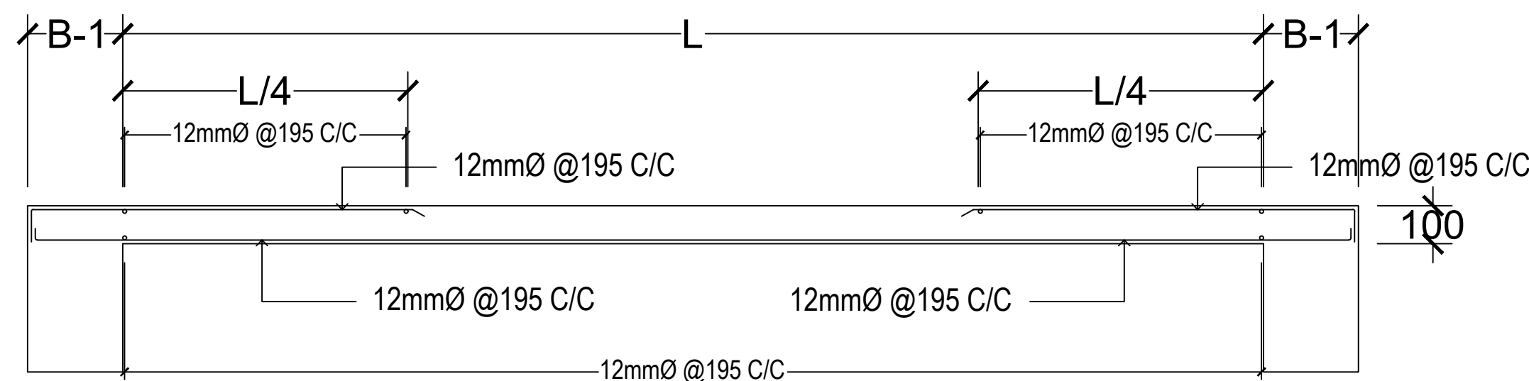
4 S-4 SLAB-1 DETAIL SCALE : 1 : 1 5 M
